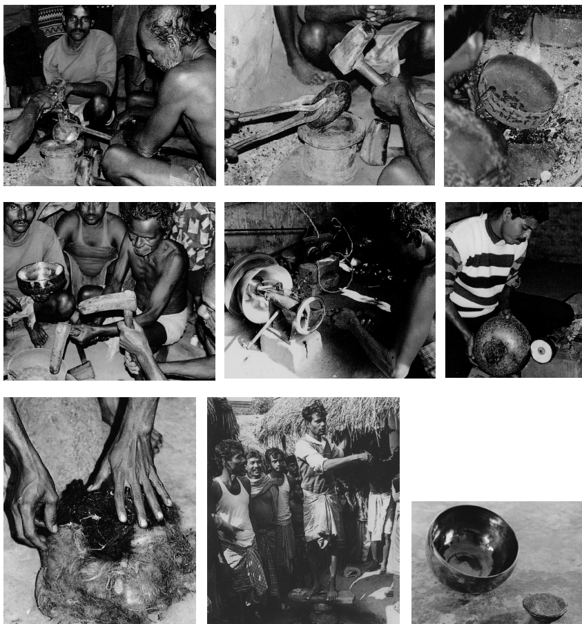
Abb. 17: Verschiedene Schritte der ACAMA-Klangschalen-Fertigung (Hess, 1999, Umschlag-Innenseite und S. 23)
